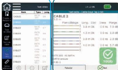
Sur le côté droit s'affiche le résultat de test du câble sélectionné à gauche
