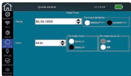
Pulse el icono **Fecha Hora** para ajustar la hora y la fecha actuales. Ambas deben introducirse en el formato específico. Además aquí se puede ajustar si la hora debe mostrarse en formato de 12 o de 24 horas.
