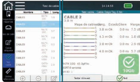
En el lado derecho se muestra el resultado del análisis del cable seleccionado en el lado izquierdo.
