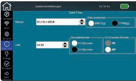
Tippen Sie auf **Datum Uhrzeit** und stellen Sie die aktuelle Uhrzeit und das Datum im festgelegten Format ein. Möglichkeit der Uhrzeit-Einstellung im 12- oder 24-Stunden-Format.
