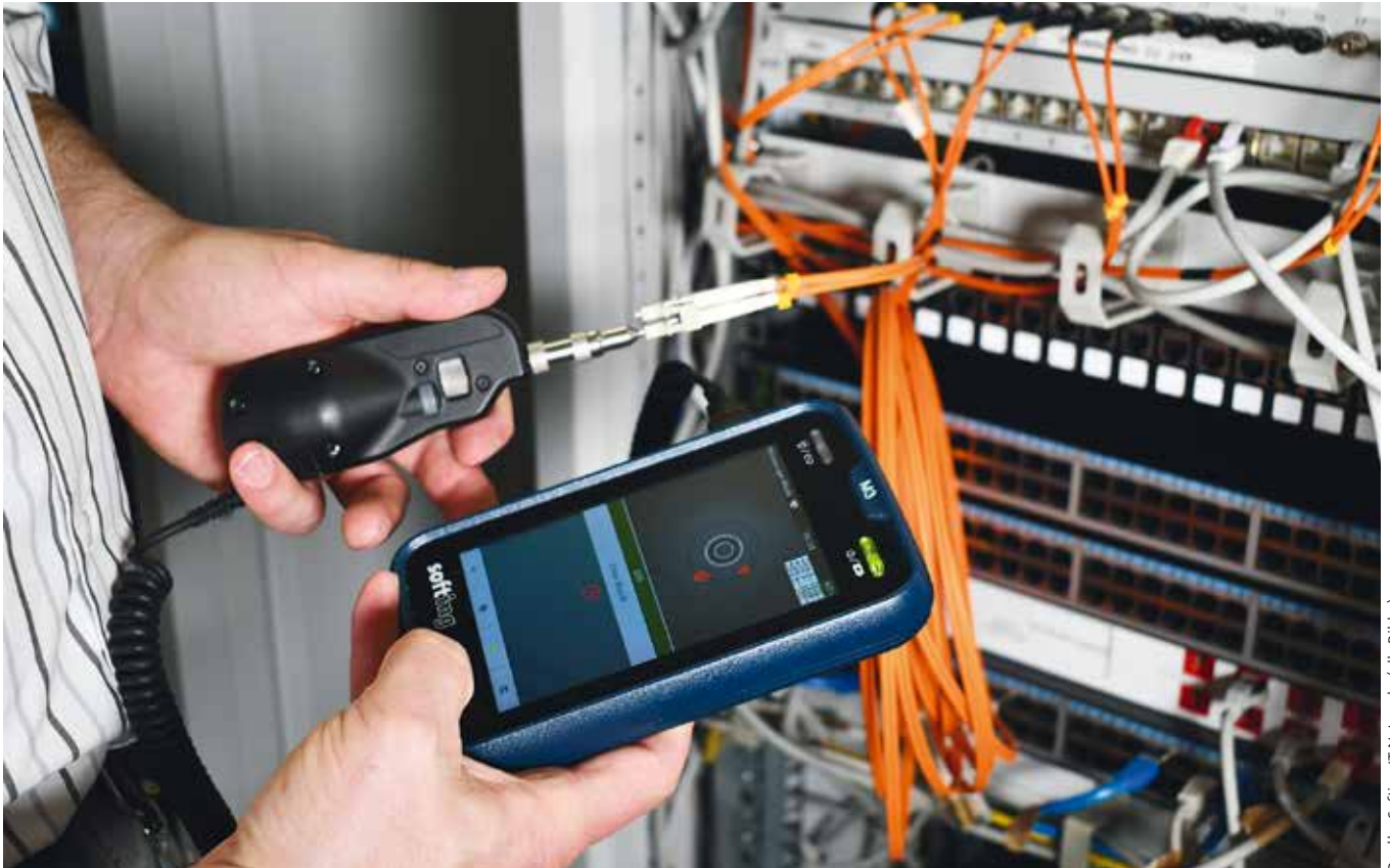
Bild 1: Steckerendflächenbetrachtung mit einem Videomikroskop und automatische Bewertung nach Norm IEC 61300-3-35
