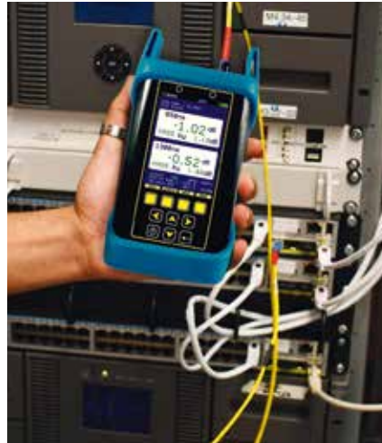
Bild 4: Dämpfungsmessung an einer LWL-Strecke mit einfachem Dämpfungsmessgerät bestehend aus getrennter Lichtquelle und Leistungsmesser
