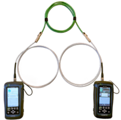
Bild 9: Messaufbau mit den Geräten von Softing: zwei Messkabel (Adapter, weiß) und Prüfling, Ende-zu-Ende-Stecke (orangefarbene Kabel mit M12-Stecker)
