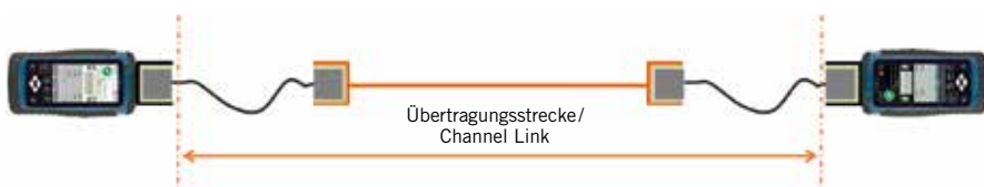
Bild 6: Bezugsebenen für die Messung einer Übertragungsstrecke/Channel Link
