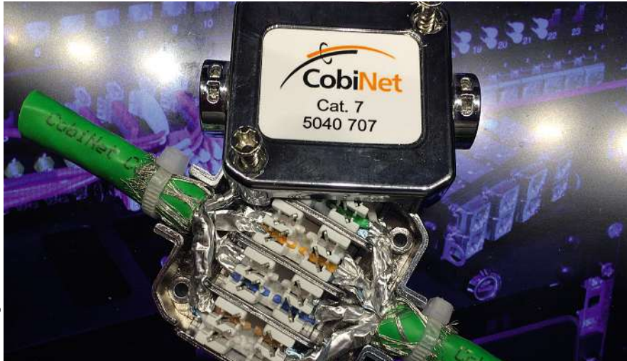
Bild 4: Modul zur Verbindung zweier Datenkabel, die Adern-Schirmung sollte bis an die Kontakte reichen, wie hier zu sehen (Cobinet)
