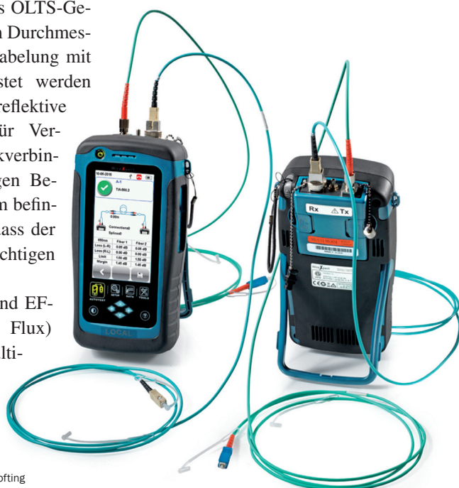
Vor- und Nachlaufkabel müssen passend gewählt sein. Im Bild das WireXpert-Messgerät.
