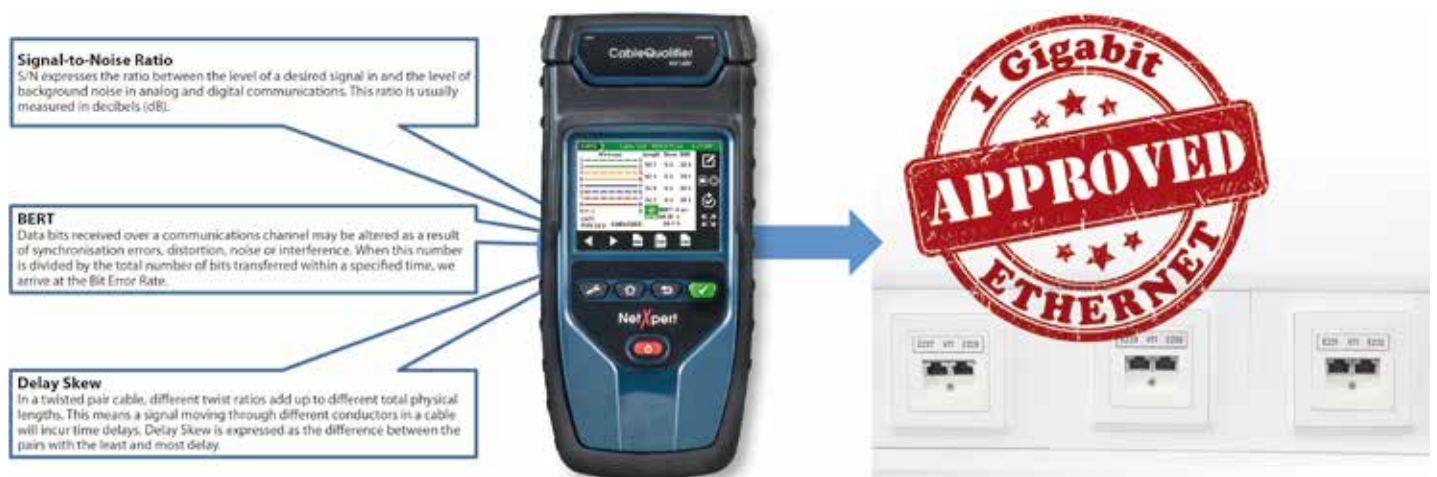
Das Leistungsvermögen einer Datenstrecke ermittelt der Netxpert 1400 über eine Kombination aus drei einzelnen Testmethoden, die als Ganzes unter der herstellereigenen Bezeichnung „Ethernet Speed Certification“ firmieren.
