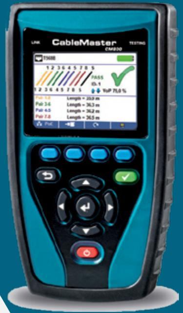
以太网供电负载测试是现今的一项重要测试，它提供关于所用标准的相关信息 - IEEE802.3af 标准 (12.95W/"PoE") 或 IEEE802.3at 标准 (25.5W/"PoE+"). 显示使用的馈电模式 A 或 B。模式 A 使用 Pin 1 和 2 输入正电压，Pin 3 和 6 输入负电压。模式 B 使用 Pin 4 和 5 输入正电压，Pin 7 和 8 输入负电压。
