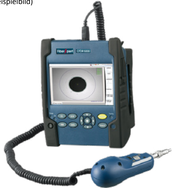
Abbildung 4: Softing FiberXpert OTDR mit angeschlossenem Videomikroskop zur Steckerendflächenbetrachtung (Beispielbild)
