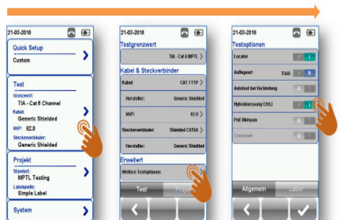
Bild 8: Freischaltung der Verwendung unterschiedlicher Mess-Adapter, um der Topologie der MPTL-Strecke zu entsprechen
