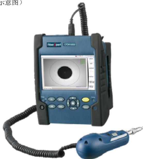
图 4：Softing FiberXpert OTDR，连接有视频显微镜，用于观测连接器端面（示意图）
