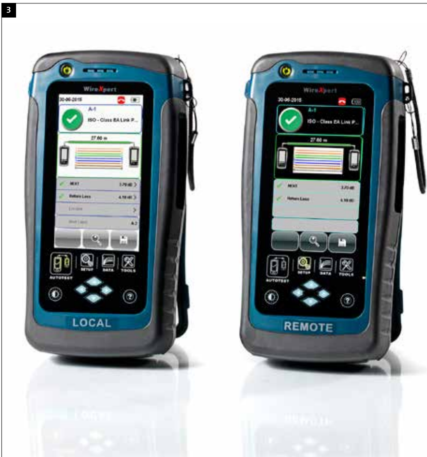
Bild 3: Ein kalibrierter Zertifizierer garantiert die Einhaltung der erforderlichen Messgenauigkeiten bei der Abnahme von Verkabelungsstrecken
